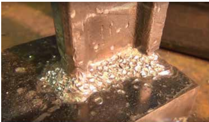
چکش کاری محل اتصال جهت تنش زدایی
