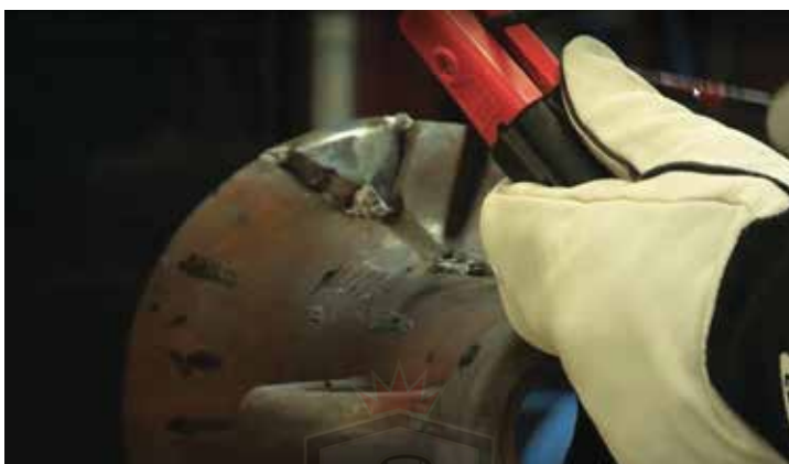
جوشکاری با رعایت اصل توالی پاسها
