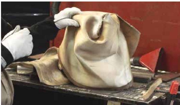
قرار دادن آستر بر روی قطعه جهت کنترل نرخ سرد شدن پس از جوشکاری
