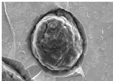
نمونه ای از ریز ساختار چدن داکتیل فریت-پرلیتی (راست) - نمایی از گرافیت کروی در زمینه فریتی تصویر برداری به وسیله دستگاه SEM (چپ)
