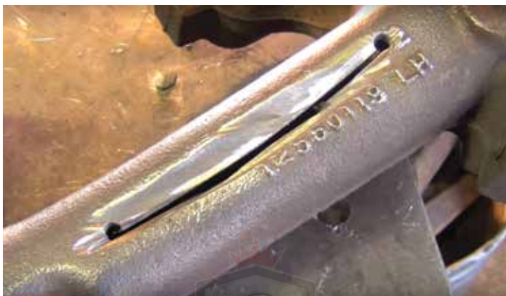
پرداخت و از بین بردن محل ترک و ایجاد سوراخ در دو طرف آن جهت جلوگیری از اشاعه آن
