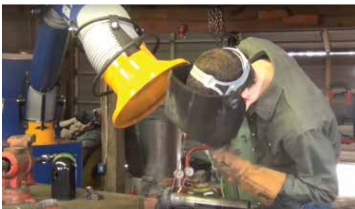
پیشگرم قطعه با مشعل اکسی استیلن
