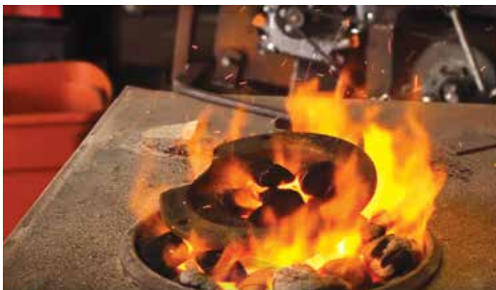
قرار دادن قطعه بر روی اجاق کارگاهی جهت پیشگرم مناسب
