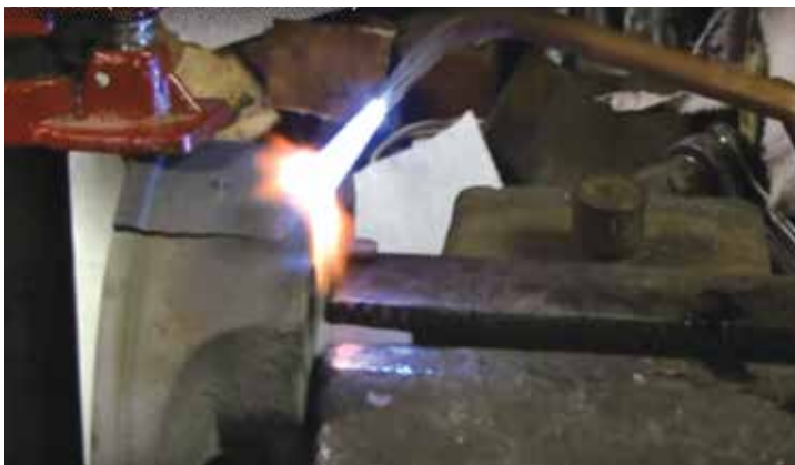
اعمال حرارت موضعی جهت انبساط و جداشدن تکه معیوب از قطعه اصلی
