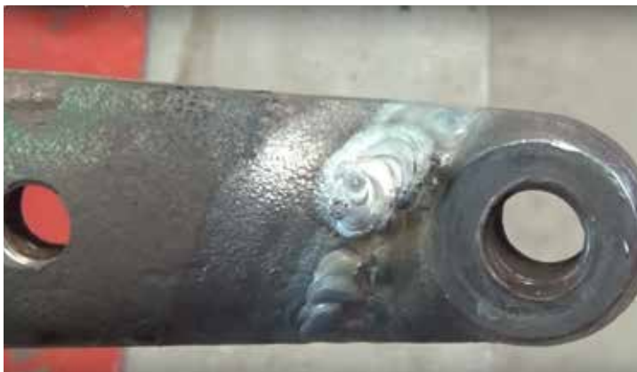
نمایی از محل جوشکاری شده با رعایت اصل توالی پاسها
