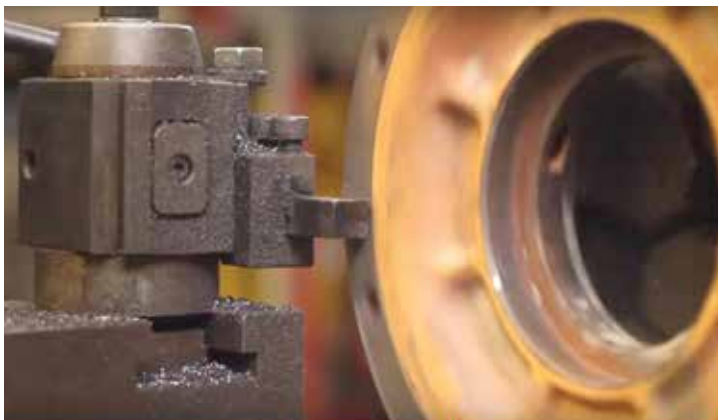
تراشکاری جهت پرداخت پاسهای جوشکاری
