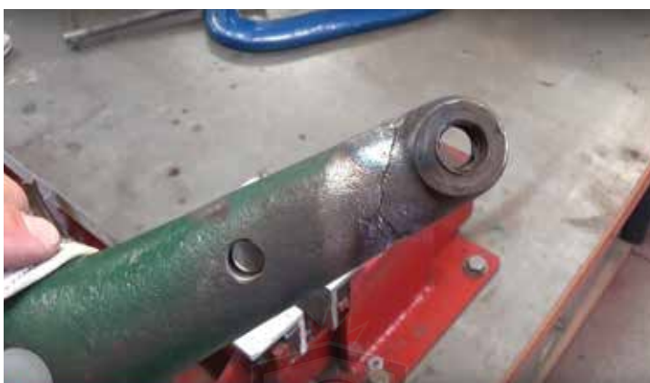
ایجاد جوش نقطه ای پیش از انجام جوشکاری نهایی و جهت استحکام دهی به محل شکست پیش از عملیات سنگ زنی
