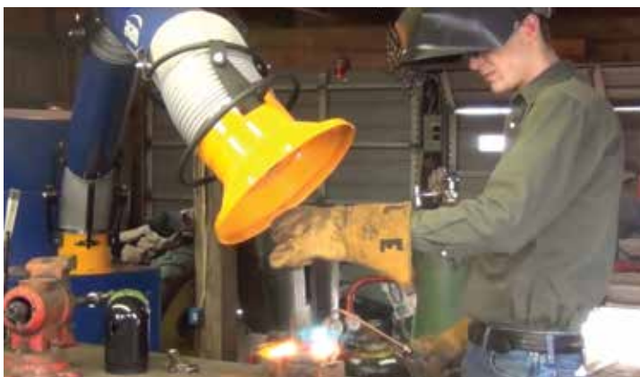
پیشگرم قطعه با مشعل اکسی استیلن
