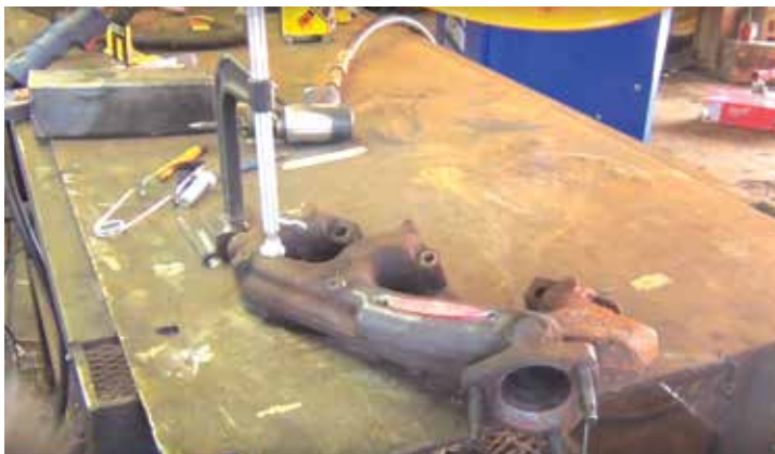
پیشگرم قطعه توسط مشعل اکسی استیلن
