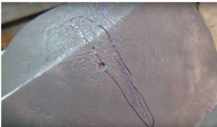
نمایی از محل ترک بر سطح قطعه
