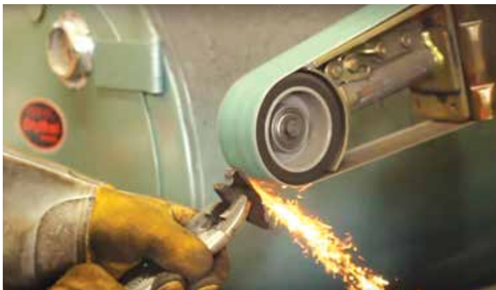
پرداخت سطحی قطعه شکسته شده جهت آماده سازی برای جوشکاری
