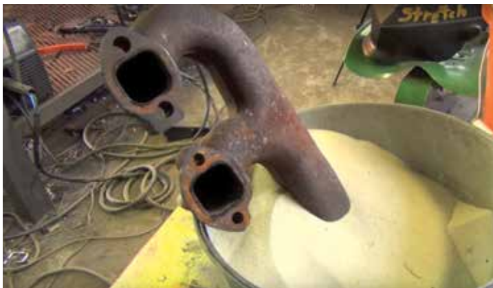
قرار دادن قطعه در ظرف شنی بلافاصله پس از چکش کاری جهت کنترل نرخ سرد شدن
