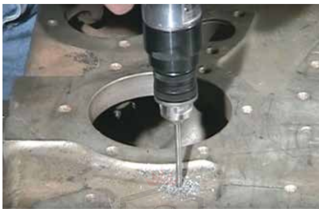
سوراخ کاری در مسیر ترک
