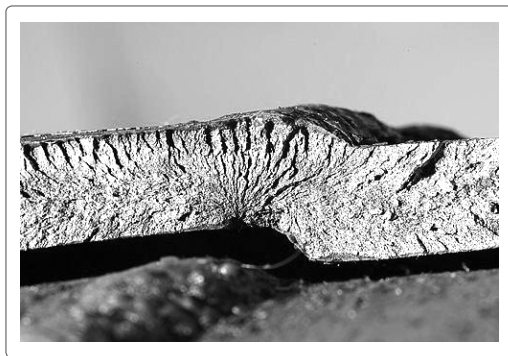
نمایی از سطح مقطع شکست یک قطعه چدن سفید
