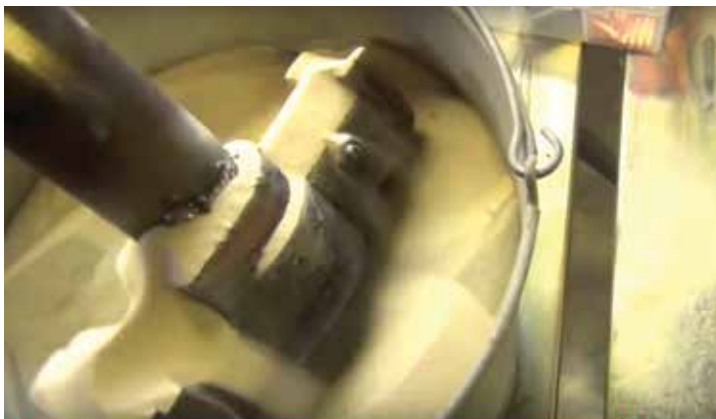
قراردادن قطعه در ظرف شن جهت کنترل نرخ سرد شدن
