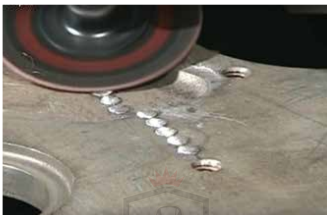
ماشین کاری پینها و مسطح سازی پینها با سطح قطعه کار
