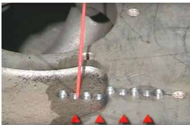
قرار دادن پین در سوراخها بصورت یکی در میان
