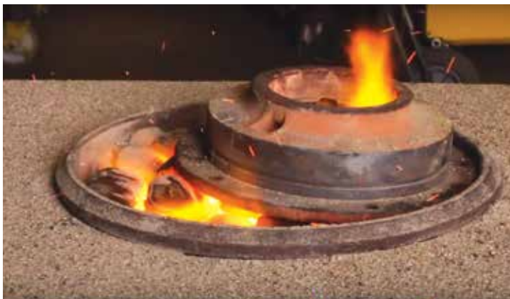
قراردادن قطعه در معرض حرارت پس از جوشکاری، جهت پسگرم مناسب و کنترل سرعت سرد شدن
