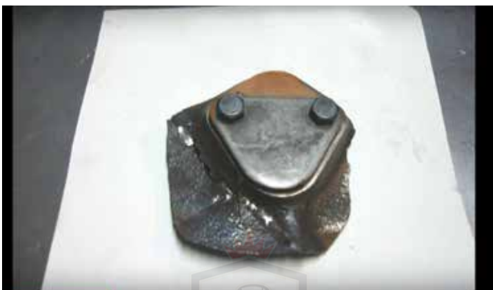
انجام جوشکاری نقطه ای پیش از انجام فرآیند اصلی اتصال دهی
