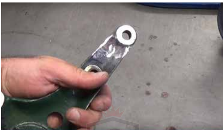
نمایی از محل جوشکاری شده با رعایت اصل توالی پاسها
