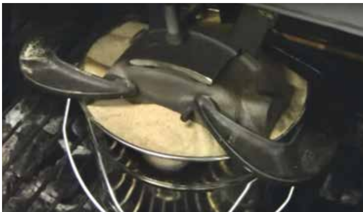
قرار دادن قطعه در ظرف شنی و قراردادن آن بر روی اجاق جهت پیشگرم ملایم و یکنواخت
