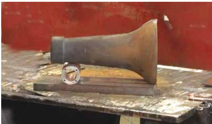
تغییر محل قطعه به جهت جوشکاری در حالت تخت
