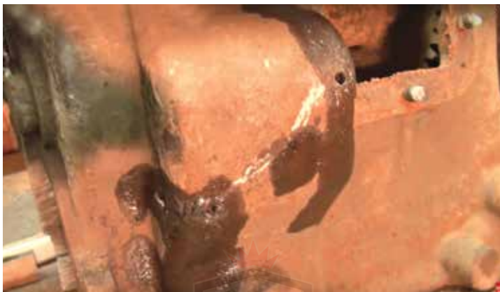
نمایی از محل شناسایی شده ترک بوسیله آزمون pt و ایجاد سوراخ در دو طرف ترک جهت جلوگیری از رشد آن
