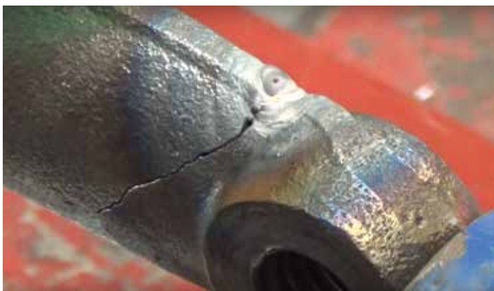
ایجاد جوش نقطه ای پیش از انجام جوشکاری نهایی و جهت استحکام دهی به محل شکست پیش از عملیات سنگ زنی
