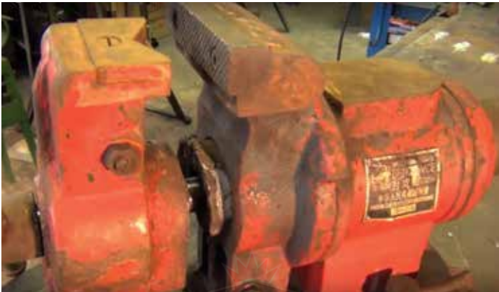
نمایی از شکستگی محل اتصال که پیشتر بوسیله فرآیند جوشکاری نادرست اتصال داده شده بود
