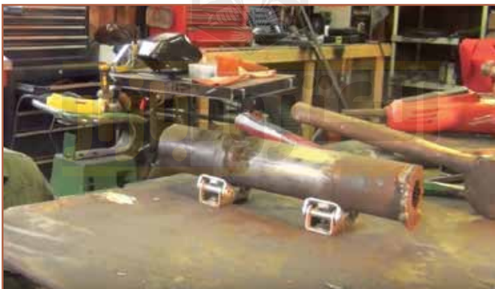
جداسازی کامل جهت اجرای صحیح پخ زنی، پیشگرم و جوشکاری و پسگرم قطعه
