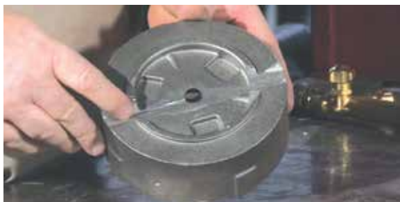
نمایی از قطعه پس از سنگ زنی و از بین بردن ترک
