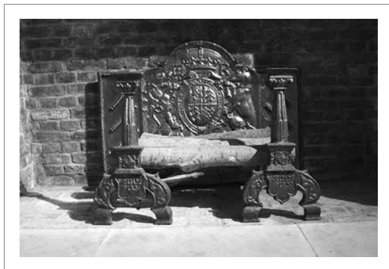
اجاق تولیدی جهت گرمایش با هیزم، ساخته شده از چدن بوسیله ریخته گری با قالب ماسه ای در انگلستان ۱۵۷۶ میلادی
